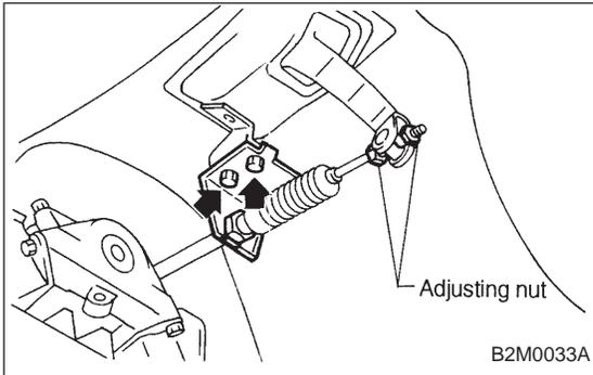
17) Remove shift selector cable. (AT model)
