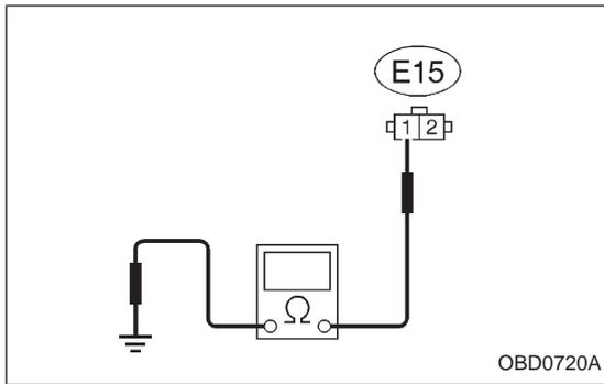
**10AC1 CHECK HARNESS BETWEEN CAM-SHAFT POSITION SENSOR AND ECM CONNECTOR.**
