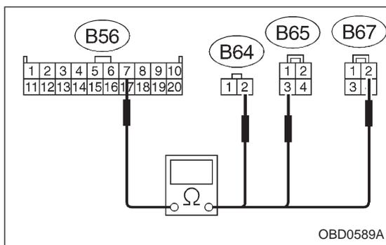
**10AS2 CHECK HARNESS BETWEEN TCM AND BRAKE LIGHT SWITCH CONNECTOR.**
