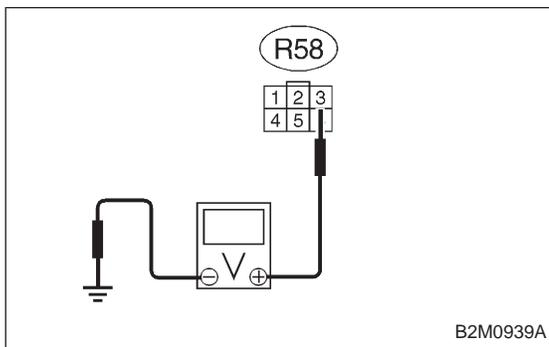
**10BP8 CHECK HARNESS BETWEEN ECM AND FUEL PUMP CONNECTOR.**
