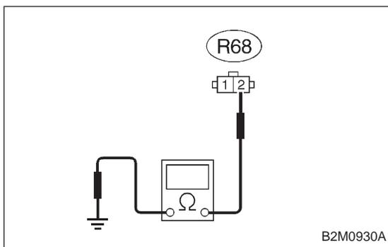
**10BN3** CHECK HARNESS BETWEEN FUEL TANK PRESSURE CONTROL SOLENOID VALVE AND ECM CONNECTOR.
