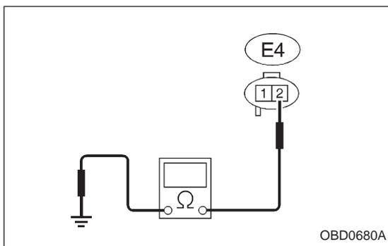
**10AI3 CHECK HARNESS BETWEEN PURGE CONTROL SOLENOID VALVE AND ECM CONNECTOR.**
