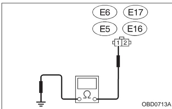
**10V3 CHECK HARNESS BETWEEN FUEL INJECTOR AND ECM CONNECTOR.**
