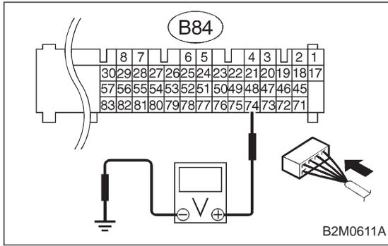
**10BQ5 CHECK SHORT CIRCUIT IN RADIATOR FAN RELAY 1 CONTROL CIRCUIT.**
