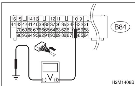
**10BN2 CHECK HARNESS BETWEEN FUEL TANK PRESSURE CONTROL SOLENOID VALVE AND ECM CONNECTOR.**
