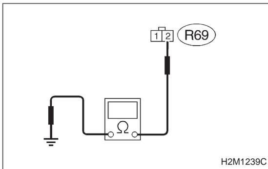
**10AJ3** CHECK HARNESS BETWEEN VENT CONTROL SOLENOID VALVE AND ECM CONNECTOR.
