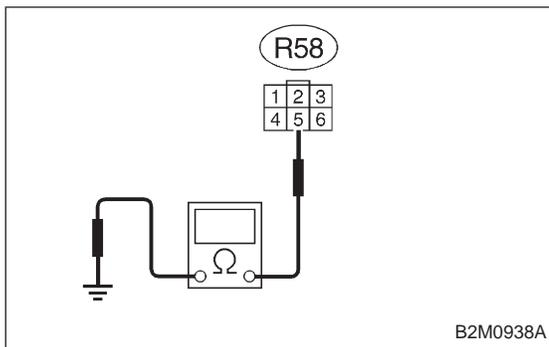
**10BP7 CHECK GROUND CIRCUIT OF FUEL LEVEL SENSOR.**
