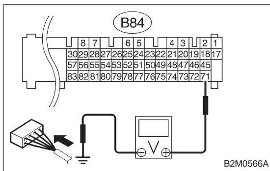
**10AE3 CHECK HARNESS BETWEEN EGR SOLENOID VALVE AND ECM CONNECTOR.**
