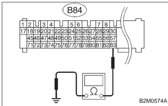
**10AM3****CHECK HARNESS BETWEEN ECM AND COMBINATION METER CONNECTOR.**
