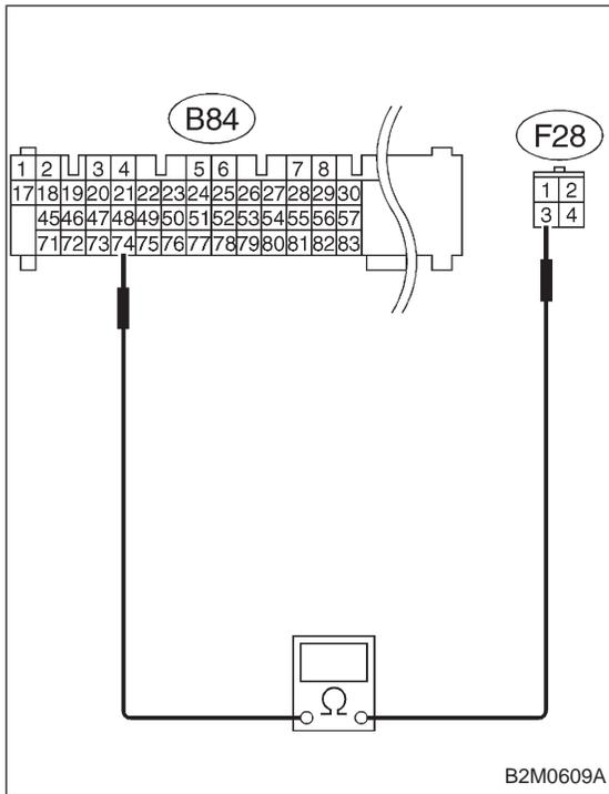
**10BQ4 CHECK OPEN CIRCUIT IN RADIATOR FAN RELAY 1 CONTROL CIRCUIT.**
