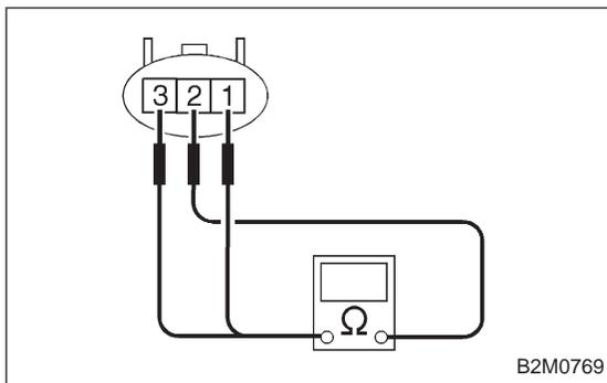
**10AN3 CHECK IDLE AIR CONTROL SOLENOID VALVE.**
