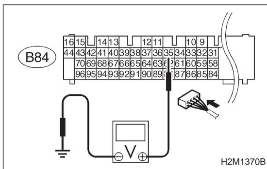
**10AJ2 CHECK HARNESS BETWEEN VENT CONTROL SOLENOID VALVE AND ECM CONNECTOR.**
