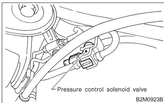
**10AG5****CHECK PRESSURE CONTROL SOLENOID VALVE.**
