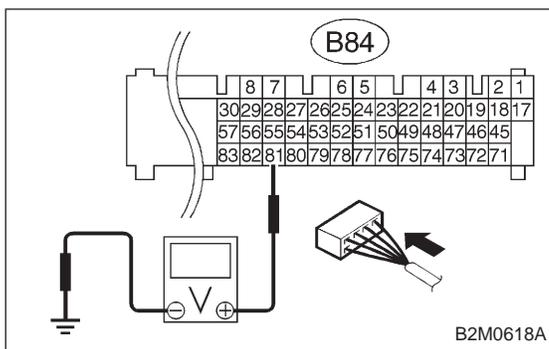
**10BW1 CHECK HARNESS BETWEEN ECM CONNECTOR AND ENGINE GROUNDING TERMINAL.**
