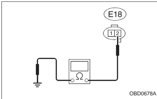
**10AE4 CHECK HARNESS BETWEEN EGR SOLENOID VALVE AND ECM CONNECTOR.**
