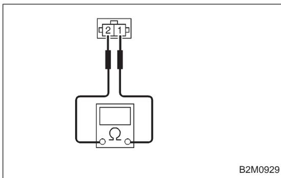
**10BN4** CHECK FUEL TANK PRESSURE CONTROL SOLENOID VALVE.
