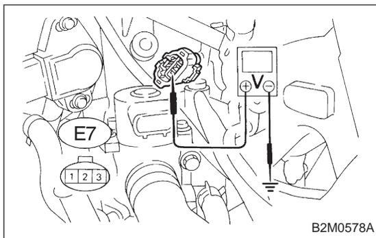
**10AN4 CHECK POWER SUPPLY TO IDLE AIR CONTROL SOLENOID VALVE.**
