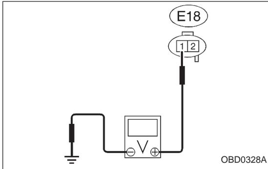
**10AE6 CHECK POWER SUPPLY TO EGR SOLENOID VALVE.**
