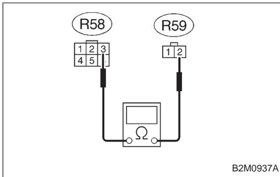
**10BP6 CHECK HARNESS BETWEEN FUEL PUMP AND FUEL SUB METER UNIT CONNECTOR.**
