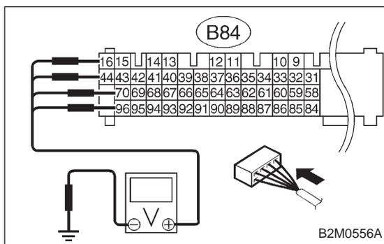
**10V2 CHECK HARNESS BETWEEN FUEL INJECTOR AND ECM CONNECTOR.**
