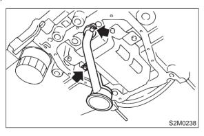
18) Remove baffle plate.
