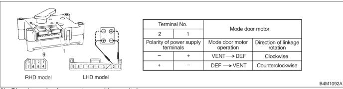
2) Check mode door motor position switch.
