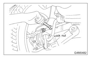
3) Tighten tie-rod lock nut.
