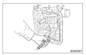
29) Using ST, remove ATF filter.
