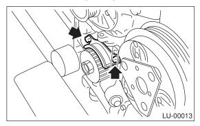
15) Remove the crank sprocket.
