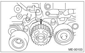
2) Install the cam sprocket.
